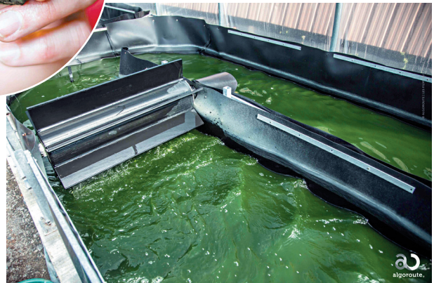
Bassins agités « Open pan system », pour la culture des micro-algues à grande échelle, développés par Alphabiotec
