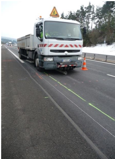
Vue du déflectographe (Aix-en-provence)
