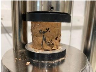
Mesure de conductivité thermique (hot disks)
