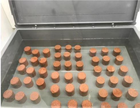
Essais attaque acide par immersion prolongée dans  $H_2SO_4$
