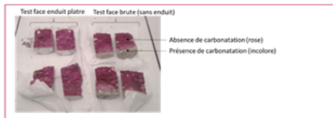
Figure 2 : Essai de flexion 3-points sur une poutre en béton armé, démontée d'un bâtiment de bureau en région parisienne. Encadré rouge : Test de carbonatation à la phénolphthaléine après carottage et fendage d'échantillon des poutres pour le même bâtiment. Ces tests mettent en avant une résistance résiduelle significative et une durabilité préservée face au risque de corrosion.
